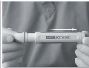
Rotar la parte roscada en sentido contrario de las agujas del reloj para desenganchar progresivamente la carcasa de la batería y separarla de la pieza de mano. Cambiarla por una batería de litio de alta calidad.
