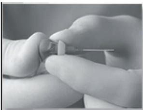
Aguantar firmemente la cabeza de la pieza de mano con el dedo pulgar mientras se sujeta con los dedos pulgar e índice de la otra mano la parte circular, blanca y grande de la punta activadora.
