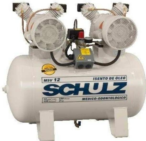
Modelo de carter seco, 220V. Dos motores con dos cabezales de compresión c/u, con sus respectivos filtros de entrada, dos cilindros cada motor. Incluye presostato automático, válvula de seguridad, manómetro, llaves de paso y despiche.
